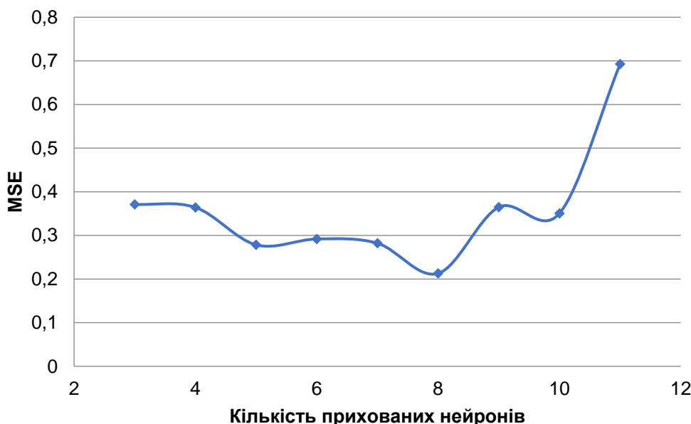
Рис. 1. Визначення оптимального числа прихованих нейронів при навчанні нейронної мережі прямого поширення сигналу
