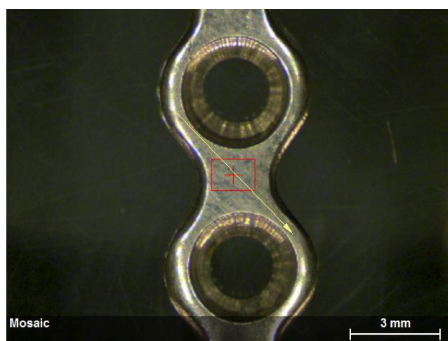
Рис. 2.6. Накісна міні-пластина виготовлена з нового низькомодульного \beta -Zr-Ti-Nb сплаву, при збільшенні \times 15 .
