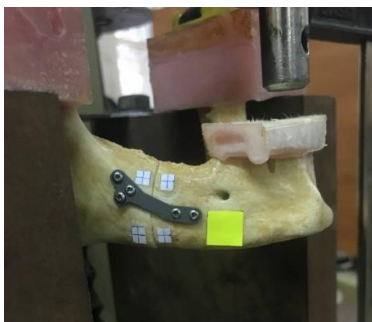
Рис. 2.2. Зафіксована в навантажувальному механізмі нижня щелепа із змодельованим переломом тіла та його фіксацією
