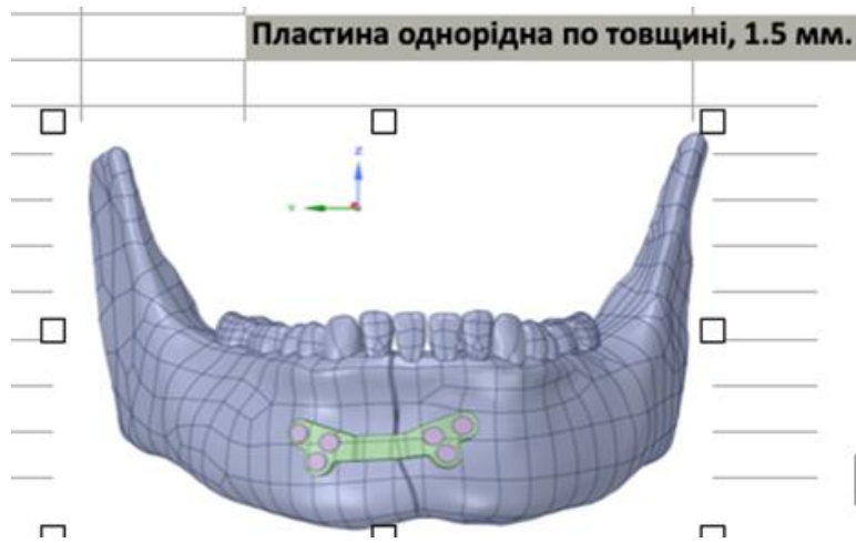
Рис. 5.17. Остеосинтезу пластиною 6-ма отворами у вигляді «метелик» при косих переломах в ментальному відділі по середній лінії нижньої щелепи (розташована ексцентрично )
