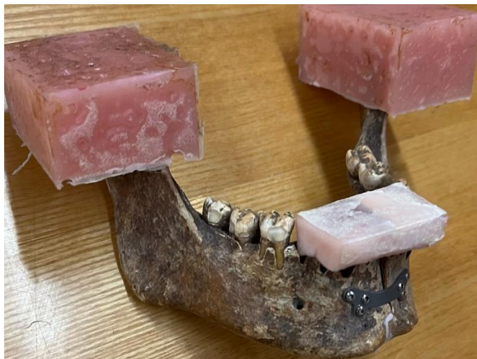
Рис. 2.1. Матеріал щелепи з виготовленими індивідуальними опорами
