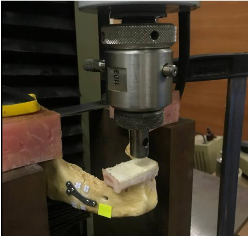
Рис. 5.25. Випробування системи «Нижня щелепа-пластина» на стиск при остеосинтезі пластиною з 5-ма отворами в ділянці тіла НЩ
