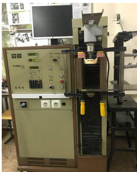
Рис. 5.23. Загальний вид машини TIRATEST-2151 для реєстрації біомеханічних результатів випробувань
