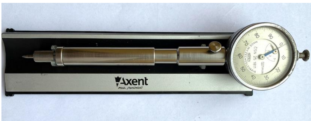
Рис. 2.12. Пристрій для визначення твердості кісткової тканини. Загальний вигляд
