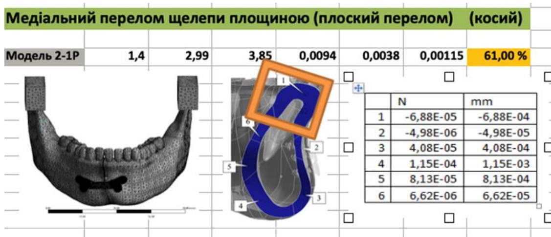
Рис. 5.19. Модель 2-1. Експериментальне дослідження НДС системи «Нижня щелепа пластина» при площинних та косих переломах в ментальній ділянці НЩ при остеосинтезі пластиною товщиною 1.5 мм. по всій її довжині
