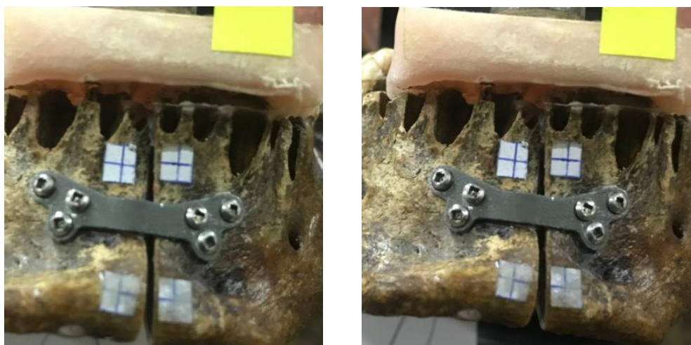
Рис. 5.33. Схеми визначення переміщень, де а – ненавантажена система, б – навантаження 150 Н
