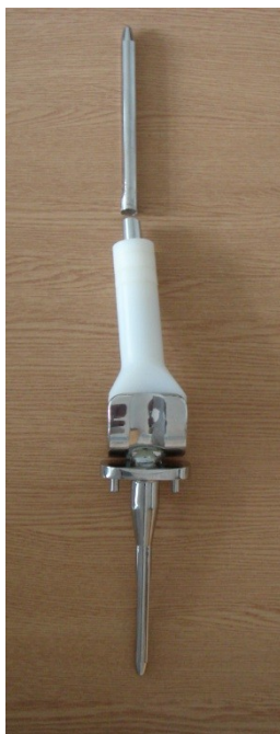
Рисунок 4.5.2 Фото видаленого індивідуального онкологічного ендопротеза із зруйнованою ніжною.
