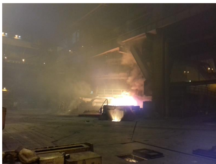
Рис. 2 – Начало выпуска чугуна (после бурения лётки)
