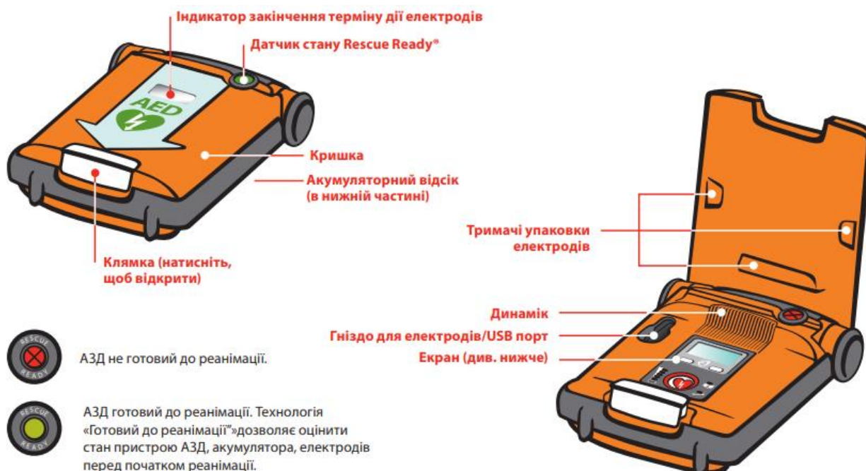
Рисунок 5.6. Частини автоматичного дефібрилятора. Згідно інструкції користувача: http://1staidplast.org.ua/wp-content/uploads/2018/02/70-01704-41-D-Powerheart-G5-Users-Guide_Ukrainian.pdf
