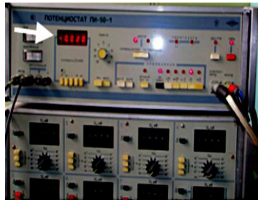
Fig. 3: Potentiostat “ПН 50-1”(“ PI 50-1 ”)
