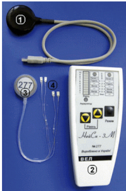
Рис. 4.5. Електронейростимулятор НейСі-3М. Зовнішня частина: 1 — антена, що передає сигнал, 2 — блок генератора імпульсів (суміщений з пультом керування); Частина, що імплантується: 3 — приймальна антена, 4 — електроди.
