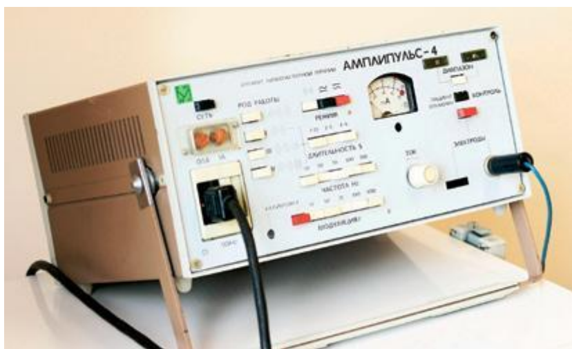
Рис 6.1. Апарат «Ампліпульс – 4» для генерації низько- та середньочастотних імпульсів для реабілітаційного лікування, який застосовували у хворих з ушкодженнями ЛН після етапу хірургічного лікування.
