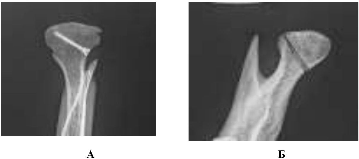
Рис. 2.4. Рентгенограми зразків після репозиції та фіксації уламків титановим гвинтом (А) та піном, виготовленим з PDLLA (пін – не рентгенконтрастний) (Б).
