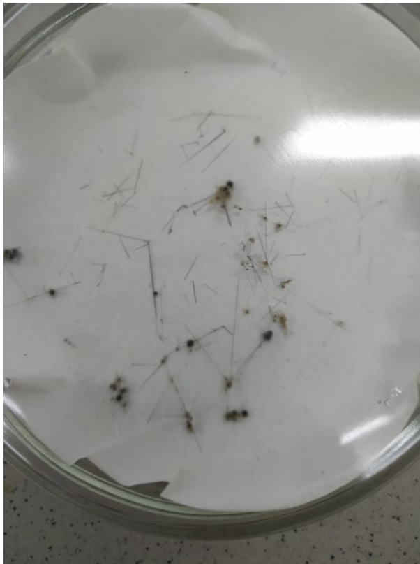
Рис. 2.1 Ниткоподібні кристали кремнію, відібрані для обробки та виготовлення імплантату
