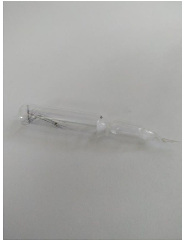
Рис. 2.2 Оброблені ниткоподібні кристали кремнію, у скляній ампулі перед імплантацією.
