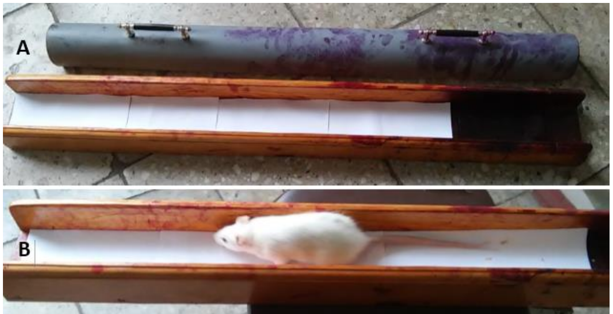
Рисунок 2.7 — Пристрій для проведення тесту «ходи по доріжці» (А), рух тварини тунелем (Б).
