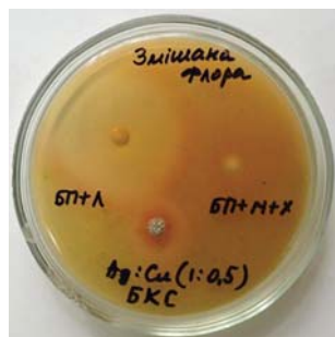
Рис. 3. Метод колодязів. Кров'яний МПА. Визначення чутливості змішаної мікрофлори пародонтальних кишень до зразків матеріалів груп порівняння.
