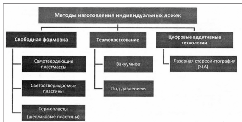
Рис. 1. Методы изготовления индивидуальных ложек с использованием различных материалов, технологических процессов и устройств
