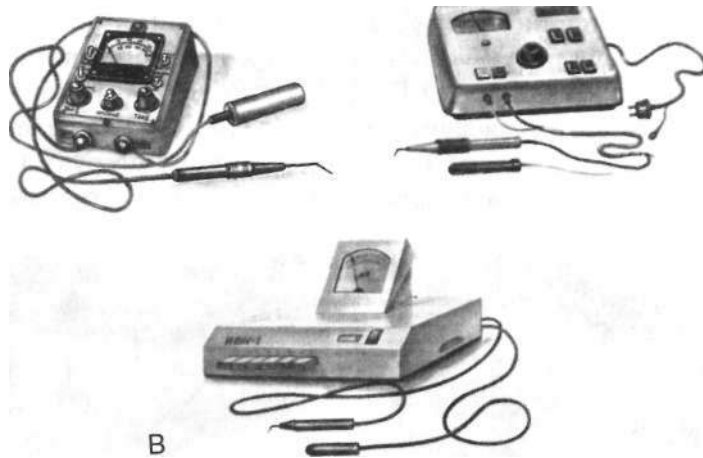
Мал. 9. Апарати для електроодонтодіагностики: А — ОД-2М; Б — ЕОМ; В — ІЗН-1
