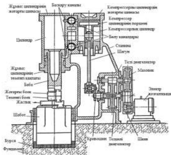
Сурет 2 - Пневматикалық балғаның схемасы
