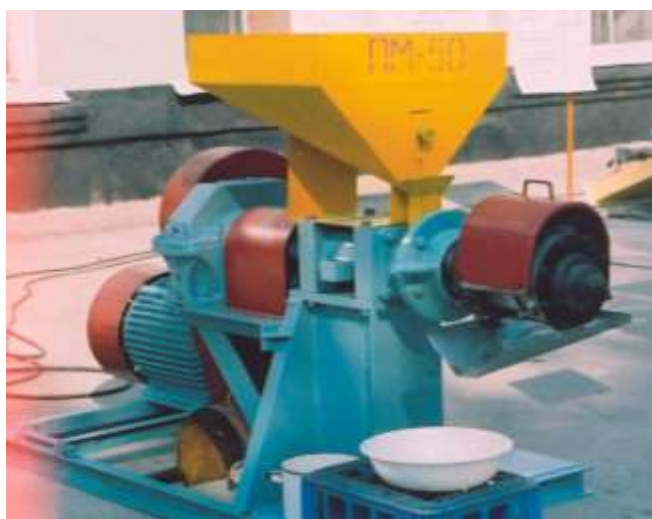
Рисунок 1 – Маслоотжимной шнековый пресс производительностью 50 кг/ч
