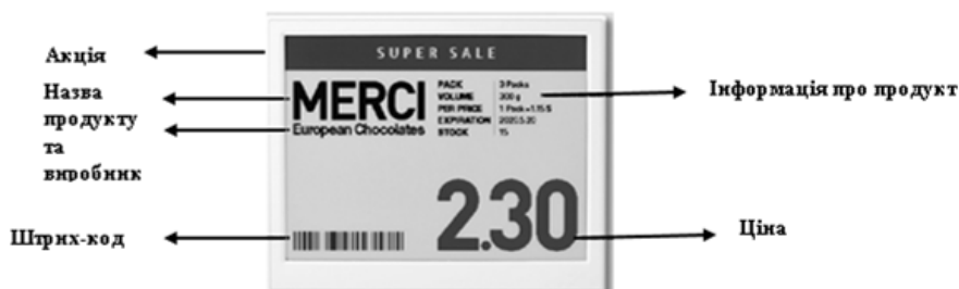
Рисунок 1 – Структура електронного цінника [4]
