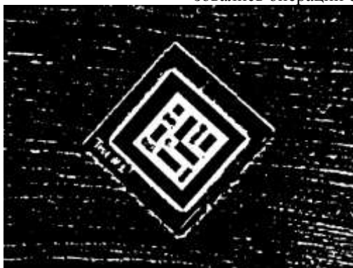
Рис. 5 Результат адаптивной пороговой сегментации
