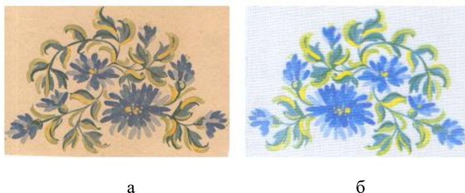
Рис. 5. Зразки барвників з модифікованою 3% ГЕК поверхню часточок термопереводного барвнику синього 3 антрахінонового і моноазобарвнику жовтого 3 з надрукованого паперу для шпалер (а) і після термопереводу з нього рисунка на полієфірну тканину (б).
