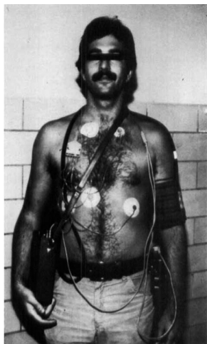
Рисунок 4.1. Конструкція апаратури, що використовувалася для отримання показників АТ та електрокардіографічних записів у 70-80-х роках минулого століття. Обладнання включало манжету для вимірювання АТ, пресуromетр, магнітофон [142].
