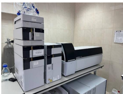
Рис. 2.1. Хроматограф Шімадзу LC-30 з триквадрупольним мас-детектором LC-8040
