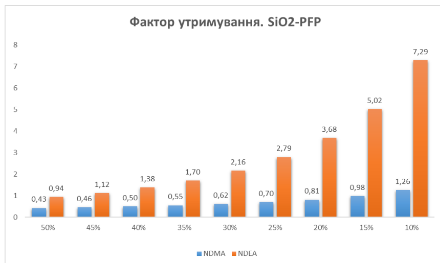
Рисунок 3.1. Фактор утримання NDEA та NDMA на колонці Discovery HS F5 250*4.6 5mkm (SiO 2 -PFP) у різних співвідношеннях етанол-вода.
