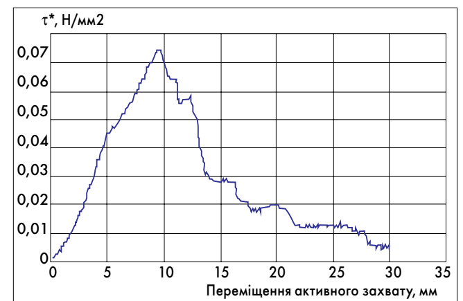
Рис. 10. Графік розтягнення та руйнування зразка комплексу «передня черевна стінка – імплантат» контрольної групи
