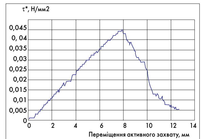
Рис. 9. Графік розтягнення та руйнування зразка комплексу «передня черевна стінка – імплантат» дослідної групи
