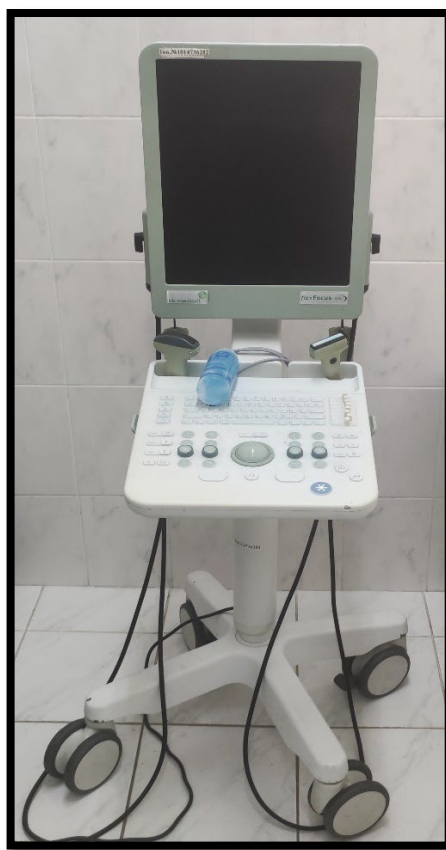
Рис. 2.2.2 Ультразвуковий апарат «Flex focus 400» виробництва «BK Medical», Данія.
