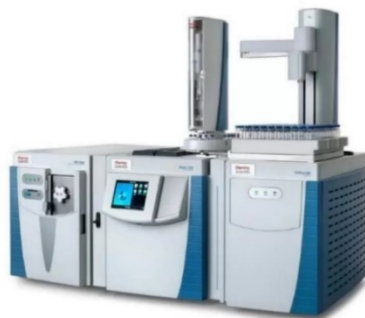
Газовий хроматографу Trace 1310 з одноквадрупольним мас-детектором ISQ™ 7000
