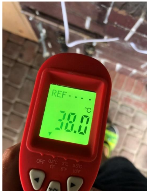
Рис. 2.4. Пірометр UNI-T інфрачервоний, що використовувався для вивчення температури досліджуваних компонентів ендопротеза під час навантаження.
