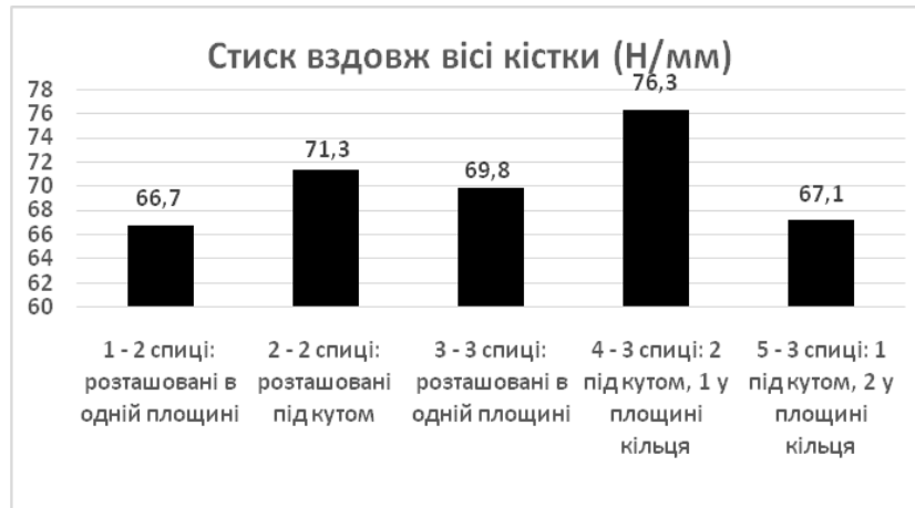
Рис. 4.8. Порівняння жорсткості системи на стиск при різних схемах компоновки.
