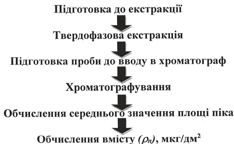
Рис. 1. - Спосіб визначення вмісту діамантового синього FCF в сорбційному матеріалі (фільтрувальний папір)
