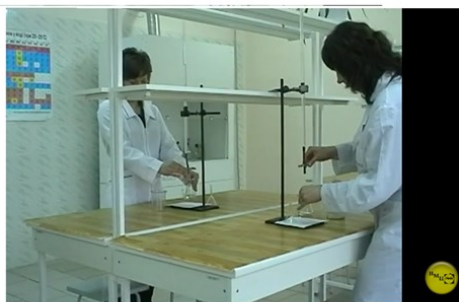
Визначення вмісту сильної кислоти в розчині методом прямого титрування
