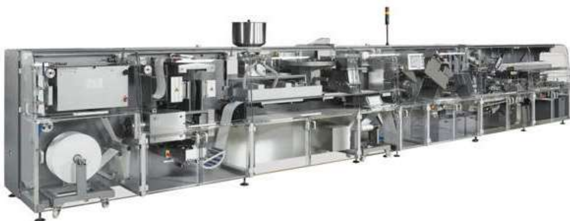
Рисунок 3.6 – Фасувальна лінія на базі моделі CP600 Картонажна машина MediSeal мод. P3000 з машиною для перевірки ваги HC та машиною пакування в поліетиленову плівку PEWO-pack 250 Compact
