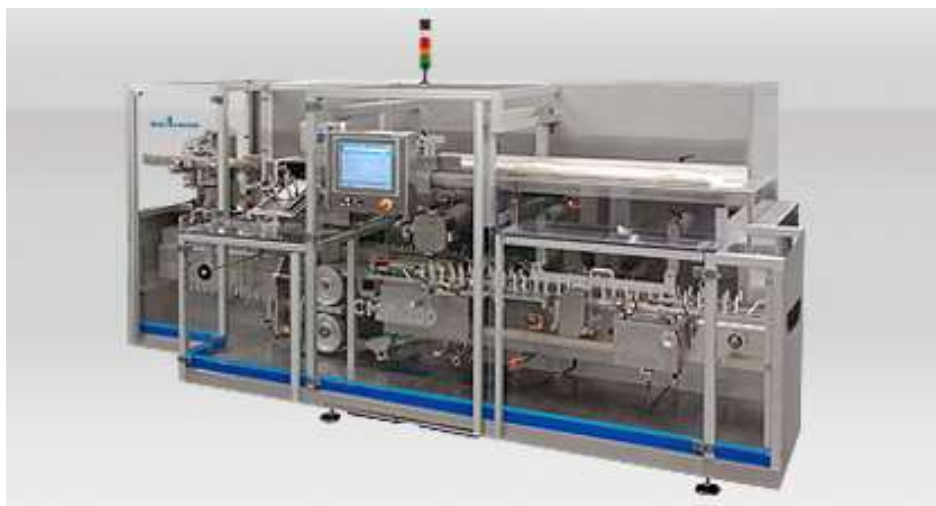
Рисунок 3.3 – Зовнішній вигляд машини для картонування СМР-200
