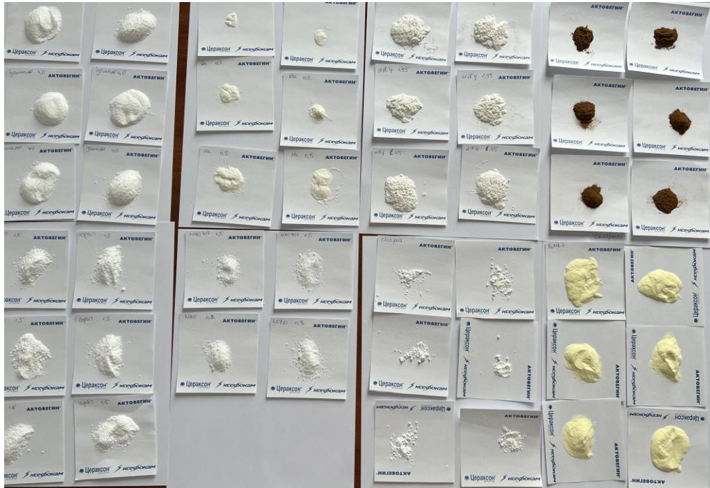
Рис.2.2. Наважки АФІ та допоміжних речовин для формування експериментальних зразків таблеток жувальних
