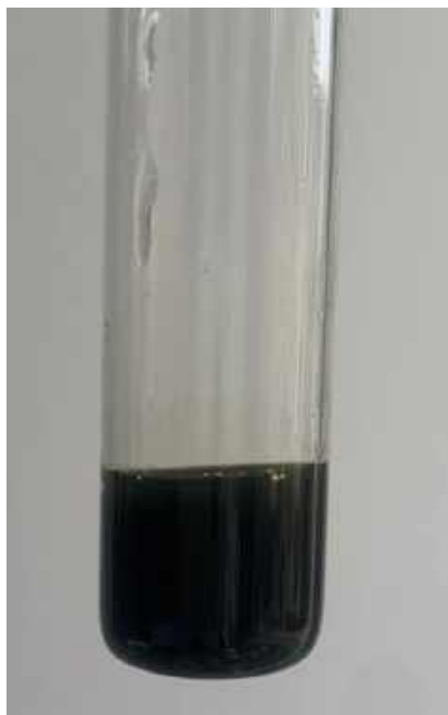
Рис. 2.3 Результат реакції водно-спиртового екстракту листа хризантеми садової сорту Вероніка з заліза (III) хлоридом
