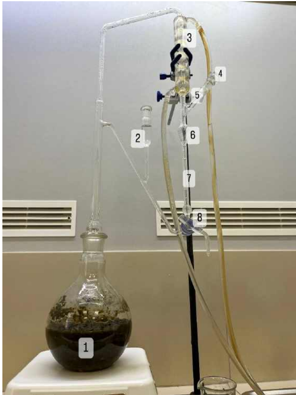
Рис.3.3.1. Прилад для перегонки і кількісного визначення ефірних олій: 1 – колба з короткою шліфованою шийкою діаметром 29мм, 2 – наливна лійка, 3 – зворотний холодильник, 4 – пробка зі шліфом і боковим отвором, 5 – скляна трубка у верхній шліфованій частині якої є отвір, 6 – грушоподібне розширення для прийому ефірної олії, 7 – градуйована трубка на 1 мл., 8 – триходовий кран.
