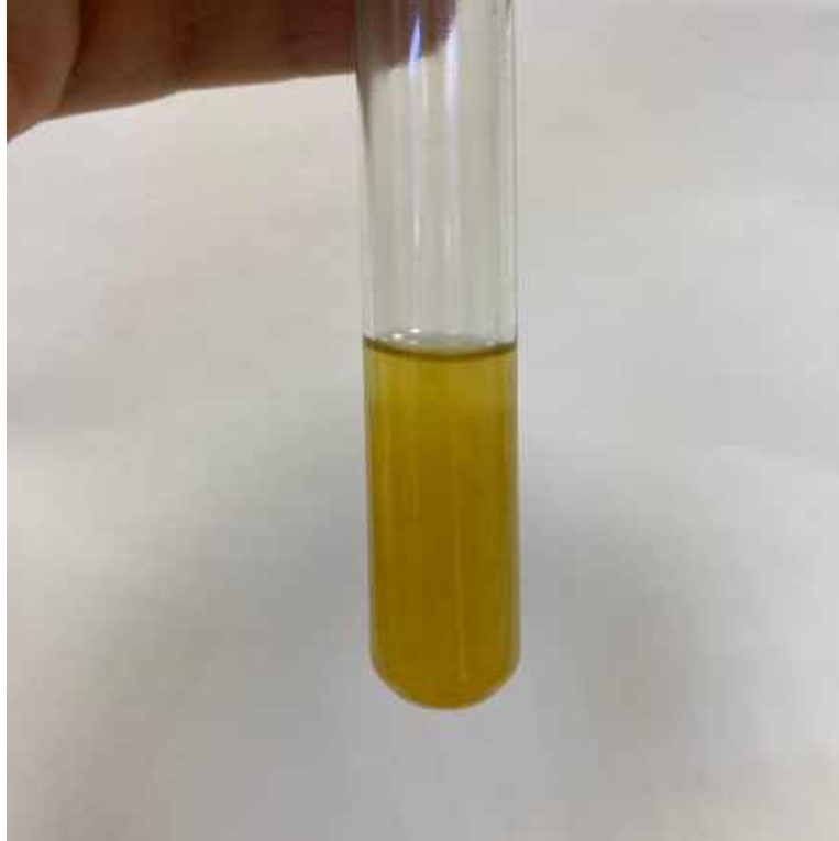
Рис.3.7. Утворення аморфного осаду в результаті реакції осадження полісахаридів етанолом
