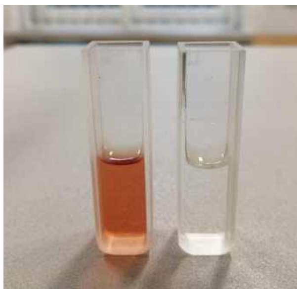
Рис. 2.16. Продукт реакції спирто-водної витяжки з верхніх стебел малини звичайної з нітрит-молібденовим реактивом
