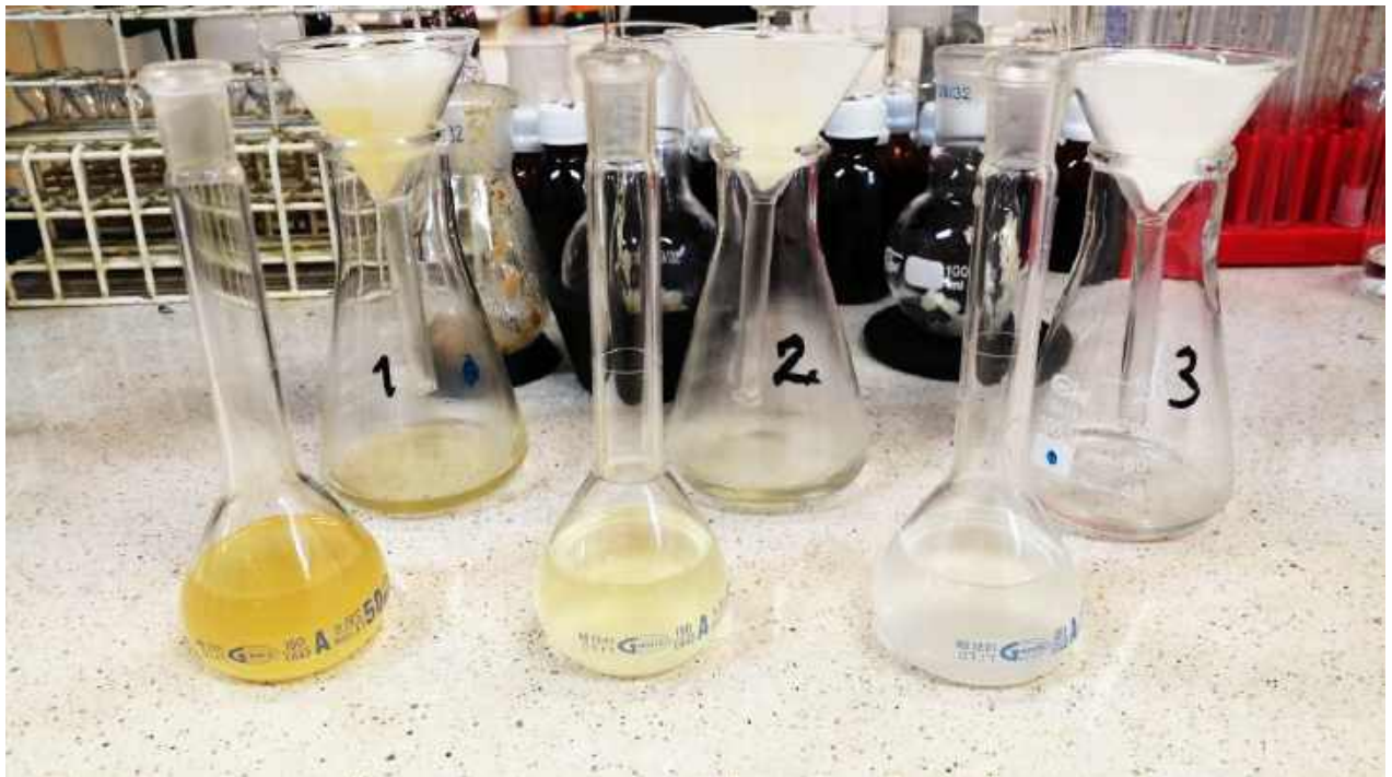
Рис. 2.12. Стадія фільтрування вихідних розчинів з кореневищ імбиру аптечного (1 – порошкова сировина, 2 – свіжі кореневища, 3 – цукати імбиру)
