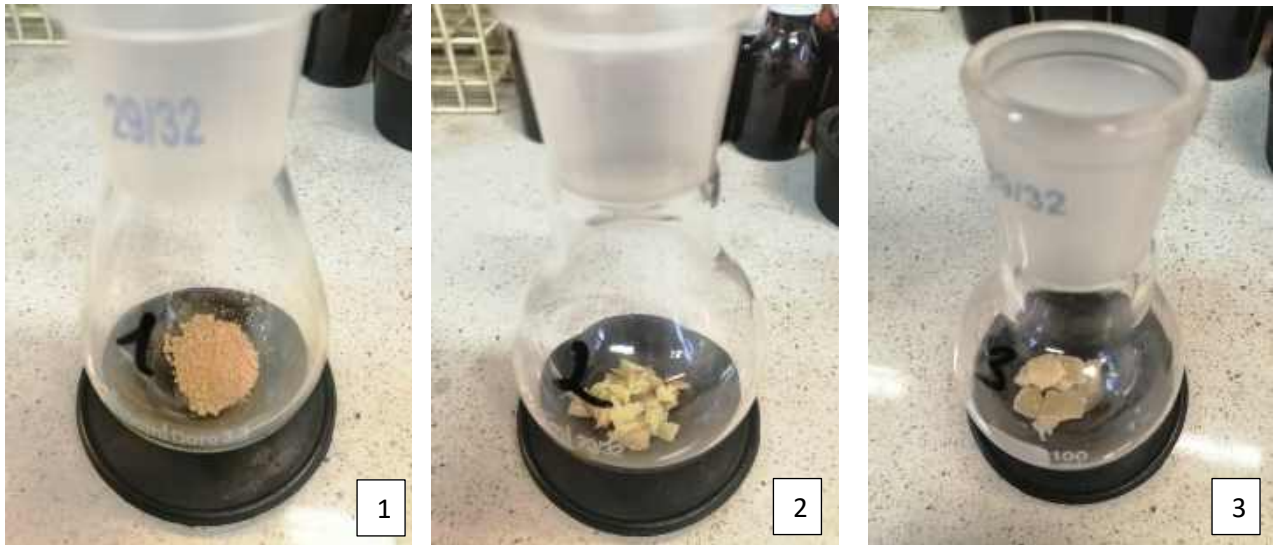
Рис. 2.11. Підготовлені рослинна сировина для приготування вихідних розчинів з кореневища імбиру аптечного (1 – порошкова сировина, 2 – свіжі кореневища, 3 – цукати імбиру)
