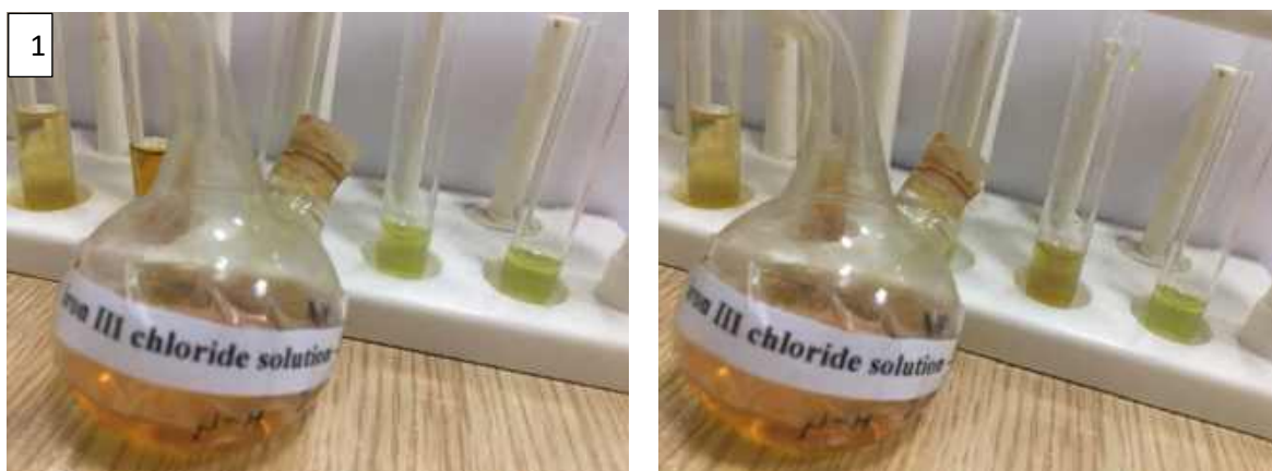
Рис. 2.10. Результат реакції водно-спиртового витягу з листя товстянки деревовидної з розчином феруму (III) хлориду (1 – до проведення реакції, 2 – після проведення реакції)
