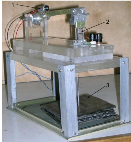
Рис. 2.2. Лабораторна зварювальна установка: 1 – лазерний датчик переміщення електрода; 2 – електроди; 3 – гирі). Діапазон тиску електродів – 0,16–11,2 кгс/см 2 . Перетин електродів – 3 × 10 мм. Товщину тканини вимірювали лазерним датчиком із роздільною здатністю ±15 мкм
