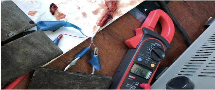
Рис. 2.20. Вимірювання температури всередині та ззовні вени за допомогою термопар in vitro
