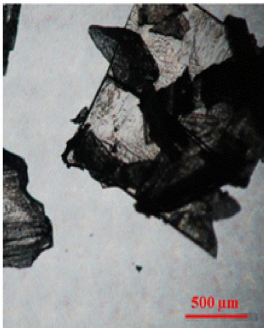
Рис.6 Оптичні мікрофотографії фенацетину, перекристалізованого з (угорі ліворуч) дихлорметану, (угорі праворуч) етанолу, (унизу ліворуч) води та (внизу праворуч) ацетонітрилу. Кристали вивчалися за допомогою поляризаційного мікроскопа Nikon Eclipse 50i POL, обладнаного цифровою камерою Nikon DS-Fi1 CCD [7].
