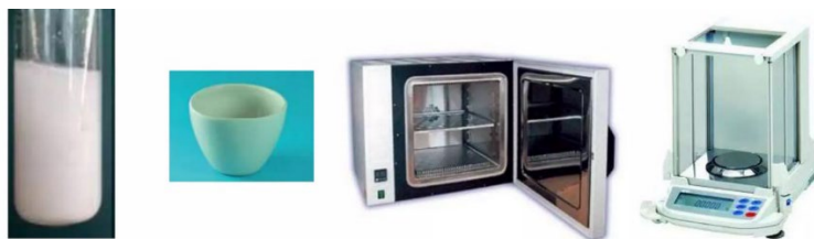
Рис. 3.6. Гравіметричний метод визначення вмісту бензилпеніциліну натрієвої солі
