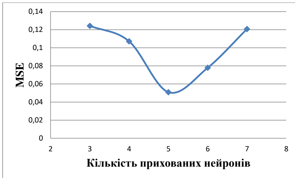
Рисунок 3.13. Залежність середньоквадратичної похибки від кількості прихованих нейронів для нейронної мережі прямого поширення сигнал
