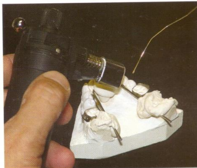
Рис. 13. Сварка деталей аппарата
