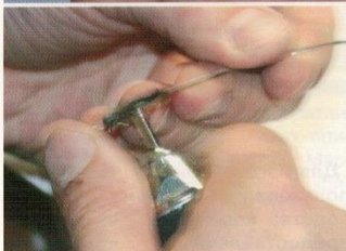
Рис. 12-14. Механическая обработка проволочных элементов
