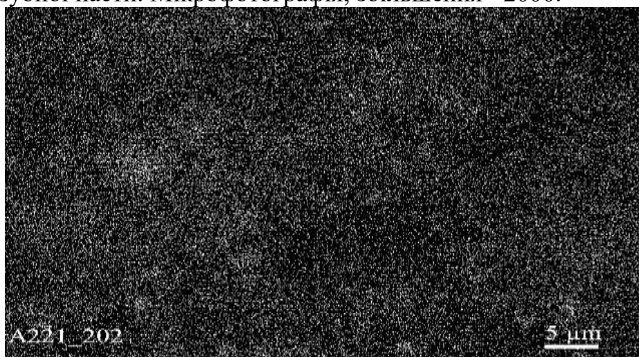
Рис. 4.35. Растрова електронограма твердої складової зубної пасти пасти «Colgate Total 12 PRO здорове дихання». Хлор рівномірно розміщений по поверхні зубної пасти. Мікрофотографія, збільшення \times 2000 .
