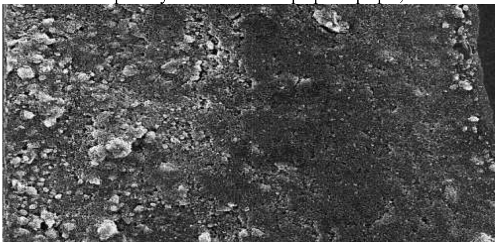
Рис. 4.10. Растрова електронограма твердої складової зубної пасти «Parodontax». Рівномірне розташування часточок натрію у незначній кількості по всій поверхні зубної пасти. Мікрофотографія, збільшення \times 300 .
