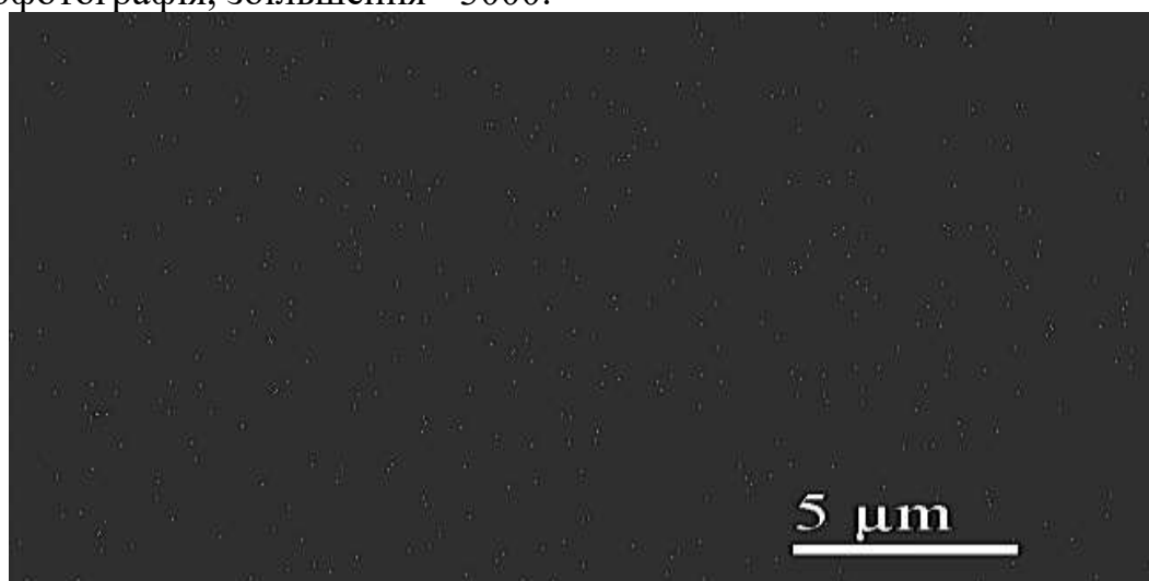
Рис. 4.29. Растрова електроннограма твердої складової зубної пасти «Lacalut Flora». Хлор у невеликій кількості рівномірно розподілений по всій поверхні пасти. Мікрофотографія, збільшення \times 3000 .
