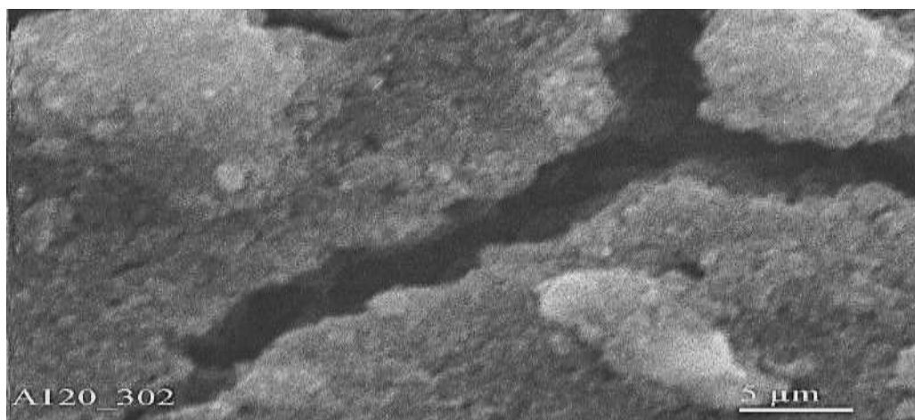
Рис. 4.27. Растрова електроннограма твердої складової зубної пасти «Lacalut Flora». Скупчення великих конгломератів. Мікрофотографія, збільшення \times 3000 .
