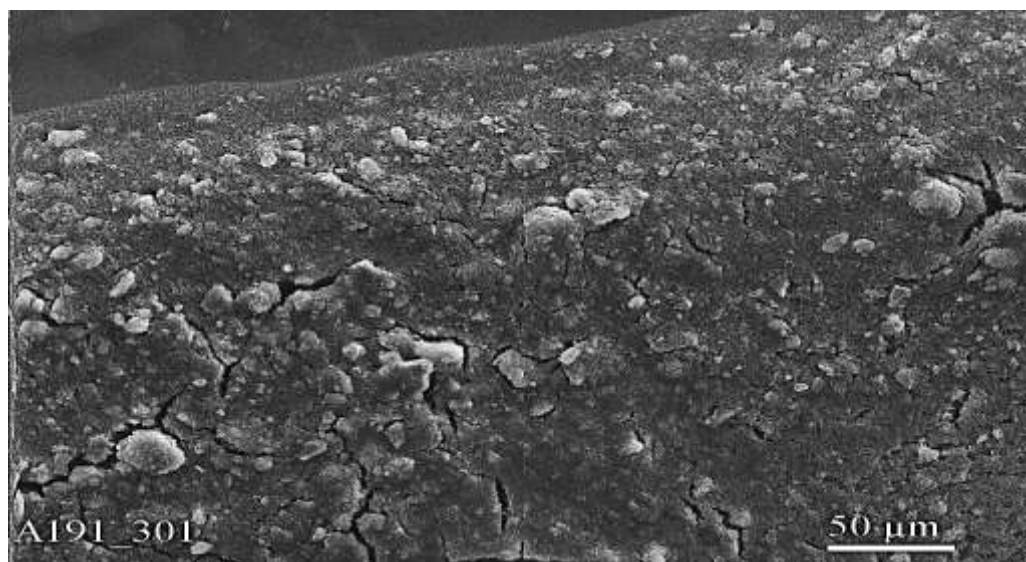
Рис.4.1. Растрова електронограма твердої складової зубної пасти «Lascalut Aktiv Herbal» на Cu-вмісній підкладці. Мікрофотографія, зб. ×300.
