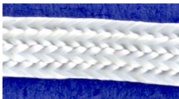
Рис. 2.4 Стрічка зі скловолокон, обплетених поліефірними мікрОВОлокнами «Поліглас». Мікрофото, збільшення \times 13
