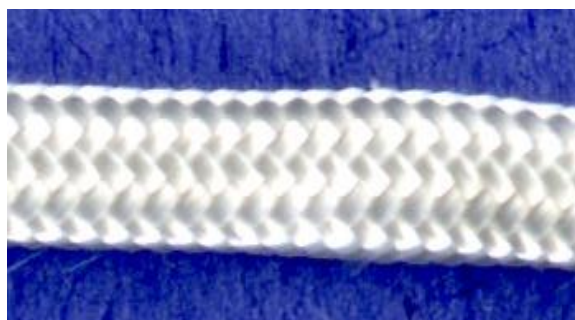
Рис. 2.6 Скловолоконна стрічка «Гласспен». Мікрофото, збільшення \times 13
