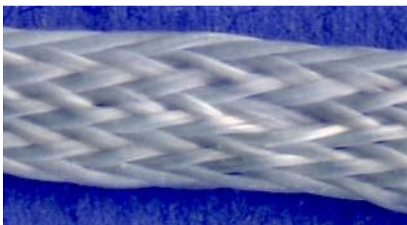
Рис. 2.5 Скловолоконний порожнинний джгут «Гласспен». Мікрофото, збільшення \times 20
