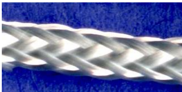
Рис. 2.2 Скловолоконний порожнинний джгут «Глассдент». Мікрофото, збільшення \times 13
