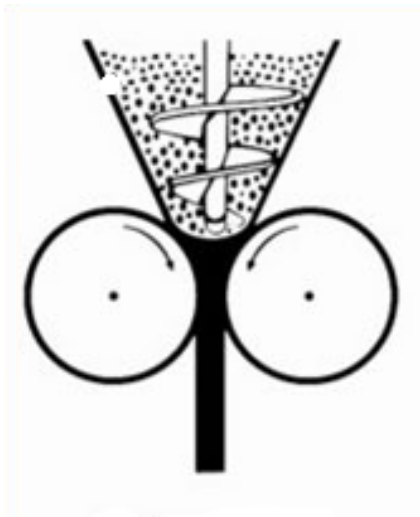
Рис. 9. Схематичне зображення процесу утворення пластинчастої стрічки на рол-компакторі
